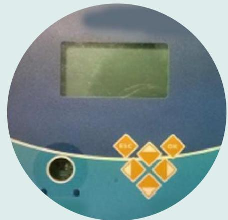
2 - Premere il tasto Ok, oppure Enter, oppure il tasto principale, oppure scorrere con le frecce per accendere il dispositivo
